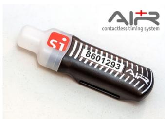
Для включения бесконтактного режима в чипах SPORTident ActiveCard (SIAC) необходимо пройти процедуру **очистки и проверки** на соответствующих станциях.
